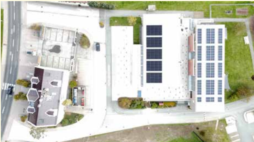
Am Dach des Turnsaals wurde eine PV-Anlage mit 35 kWp und einem 58 kWh-Speicher installiert.
